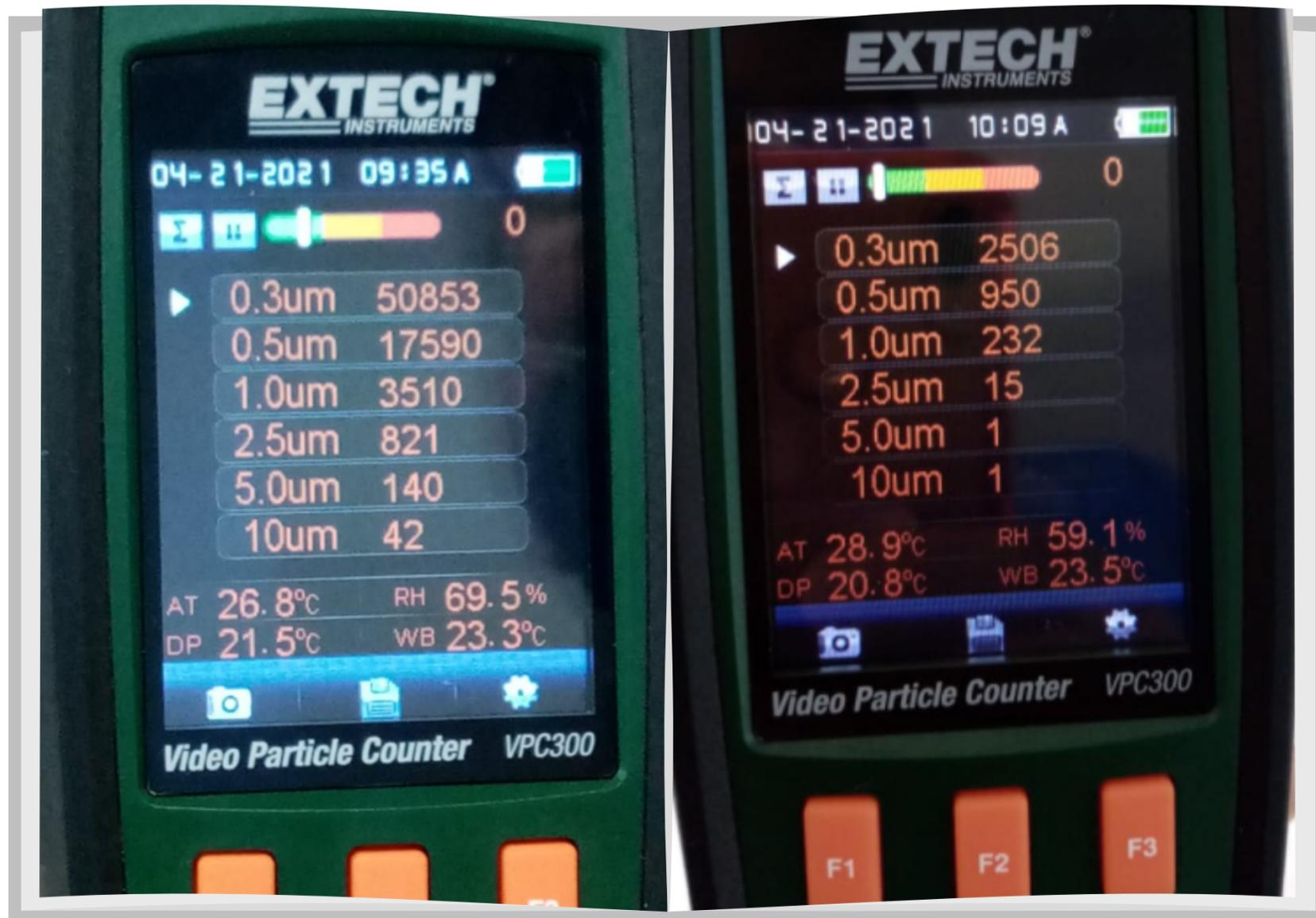
En este resultado promedio pudimos verificar, antes de la colocación del OptiClean, una lectura de **50,853** partículas de 0.3 micras y después de la puesta en marcha **2,506** partículas, logrando una disminución en un **96%** de las mismas en los márgenes del standard ISO 6 en conteo de partículas para el área de salud.
